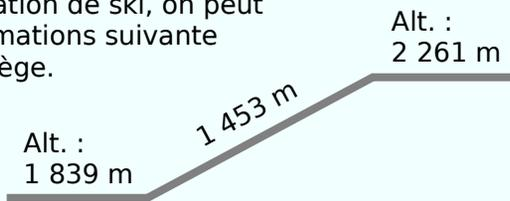
Calcule l'angle formé par le câble du télésiège avec l'horizontale. (Arrondis au degré près.)
